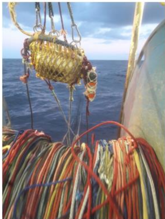
Dispositif de pingers (système de répulsion acoustique) placés sur les chaluts pélagiques
