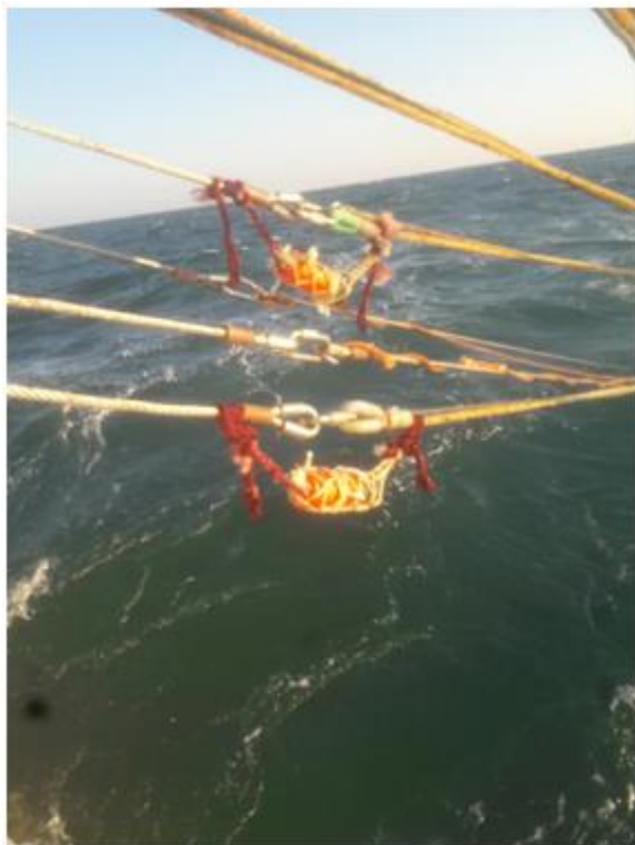
Dispositif de pingers (système de répulsion acoustique) placés sur les chaluts pélagiques
